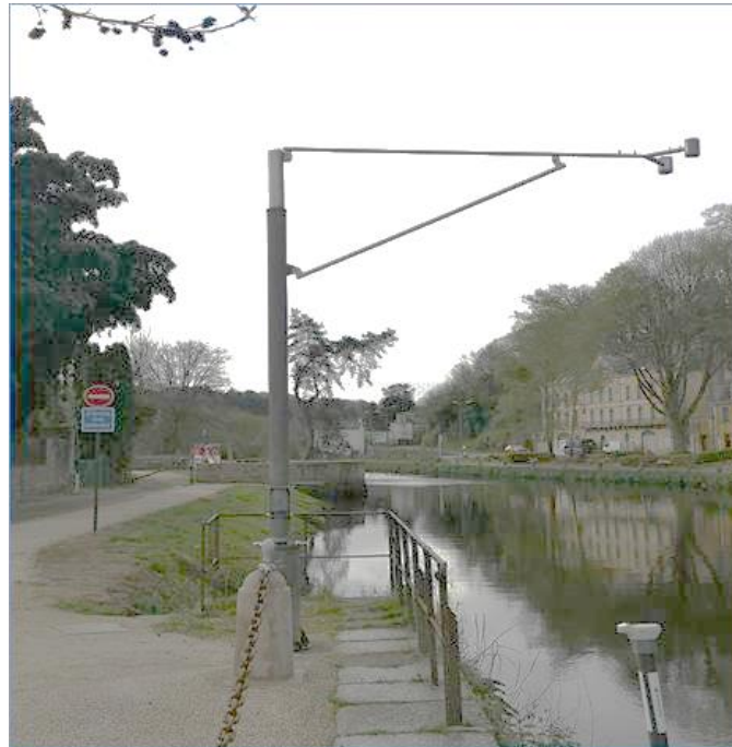
Photo 67 : Station hydrométrique radar de la DREAL installée début 2022 Quai Surcouf à Quimperlé
